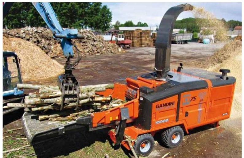
(четыре в опции), размещаемые в загрузочном бункере, предназначены для облегчения подачи объемистого материала. Они кроме того помогают разрушить возможные инородные предметы, находящиеся между измельчаемыми сучьями и стволами (земля, камни и прочее) что сокращает затраты времени на обслуживание и облегчает его. Смазывание всех точек централизовано).
