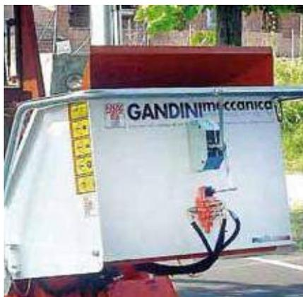
**Ручка безопасности и управления** установлена по периметру приемного окна и соединена с устройством управления. При нажатии на нее во время работы измельчителя происходит мгновенный останов подающих валцов.
