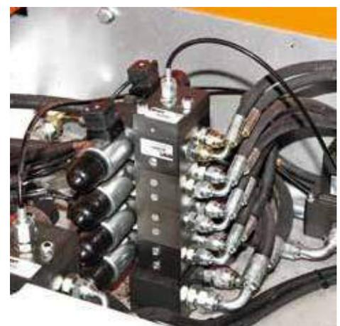
Мощные эпициклические мотор-редукторы в масляной ванне вращают вальцы с зубьями. Контуры гидросистемы работают под низким давлением с фильтрацией масла, что гарантирует исправную работу системы без перегрева. Это способствует увеличению срока службы оборудования и стабильности в процессе работы. Показания величин давления выводятся на бортовой дисплей управления машиной.
